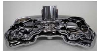
ユニプレス超扁平型トルクコンバータ
