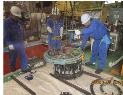
プレス保全中級教育風景(クラッチブレーキ点検実技)
